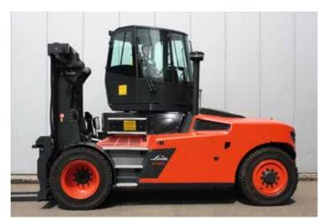
Ebenfalls für den Linde-Schwerlaststapler 1401 erhältlich ist eine Drehkabine. Die Drehkabine erlaubt dem Fahrer, die komplette Kabine stufenlos bis zu einem Winkel von 90° nach links und 65° nach rechts zu drehen. Zusätzlich abrufbar ist eine Volldrehung um 180° nach links.
